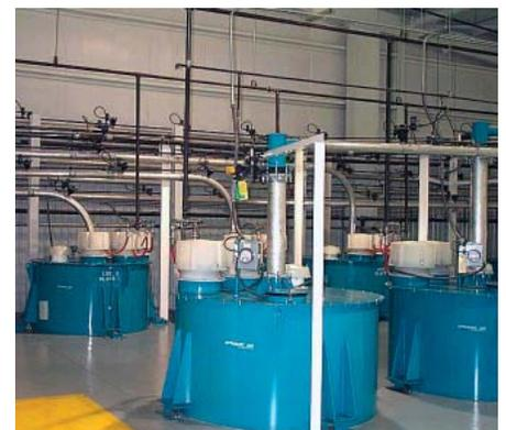
*Verschiedene Zwischenbunker von 0,6 m<sup>3</sup> mit Modu-Kleen® 669 Bunkerentlüftungsfilter*
