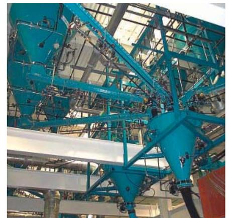
*Die Hochpräzisionszubringer Dyna-Slide™ befördern Material aus Zwischenbunkern von 6 m<sup>3</sup> zu Trichterwaagen.*
