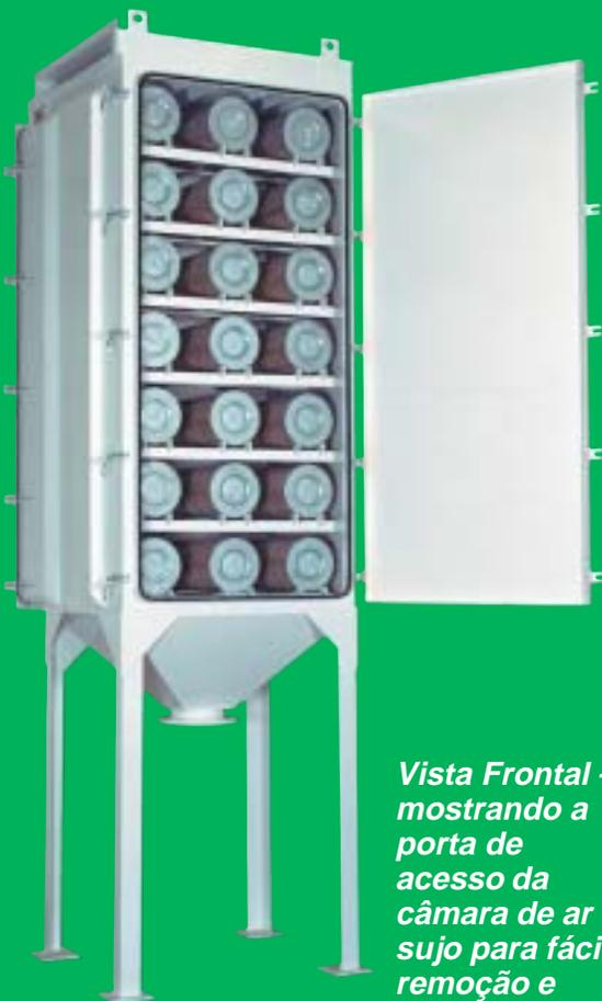
*Vista Frontal – mostrando a porta de acesso da câmara de ar sujo para fácil remoção e inspeção dos cartuchos.*
